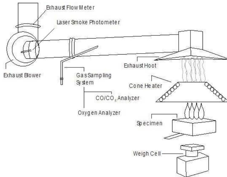
Fig. 2. Cone calorimeter
